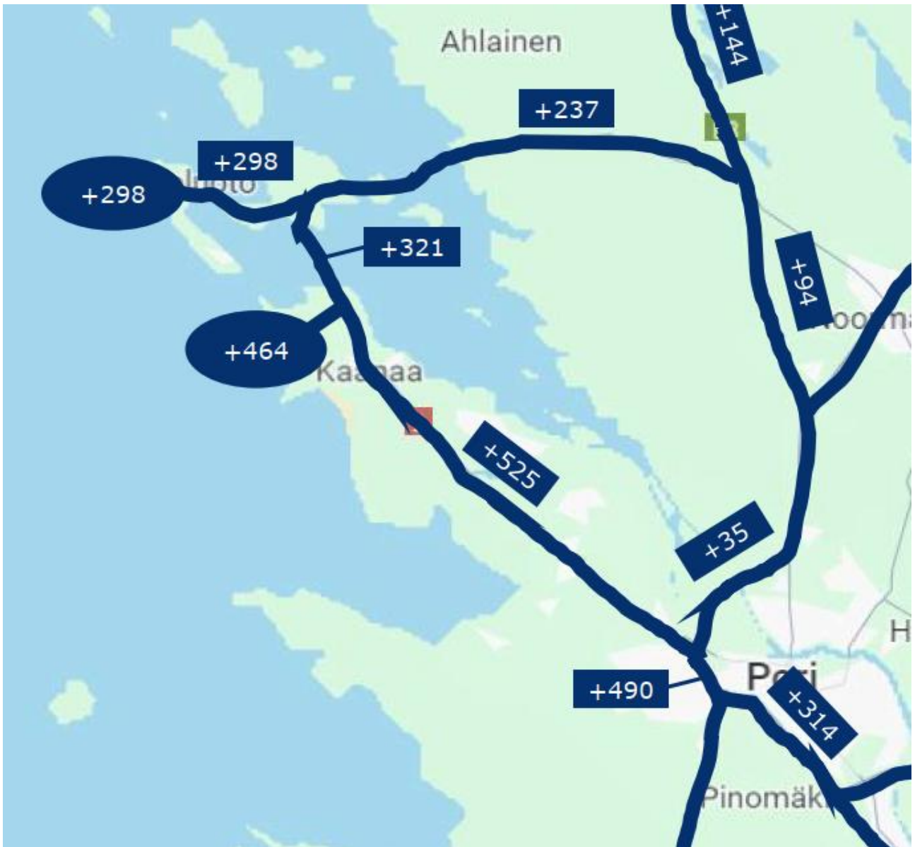
Kartassa Tahkoluodon ja Mäntyluodon uusien hankkeiden aiheuttama raskaan liikenteen kasvu pääväyillä: ajon./vrk. Lähde: Liikenne-ennuste 18.6.2024 / Ramboll.
